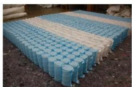
БОНЕЛЬ – является зависимым пружинным блоком, пружины которого расположены в один ряд и соединены с помощью спиралей с соседними рядами. Бонельный блок пружин относится к устаревшей технологии и сейчас используется лишь при изготовлении матрасов эконом класса и самых дешевых диванов. Матрасы с таким пружинным блоком трудно назвать ортопедическим, так как во время сжатия какой-то одной пружины сжимаются и все соседние. А уж скрип данных матрасов в комментариях вообще не нуждается.
